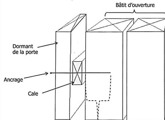
Porte : Une vis par charnière doit pouvoir pénétrer le poteau d'au moins 25 mm (1 1/2 po). L'utilisation de vis n°10 est recommandée.
